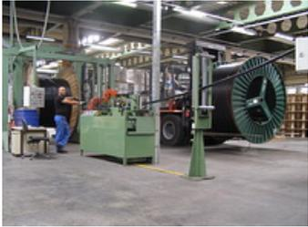
**2006:** Logistikerweiterung durch Inbetriebnahme einer neuen Umrollanlage bis 14 Tonnen Einzelgewicht
