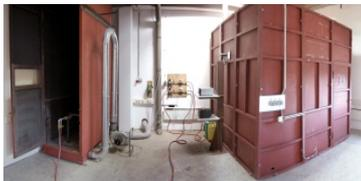
**2003:** Installation und Inbetriebnahme eines Prüfzentrums und Brandlabors für FRNC Kabel
